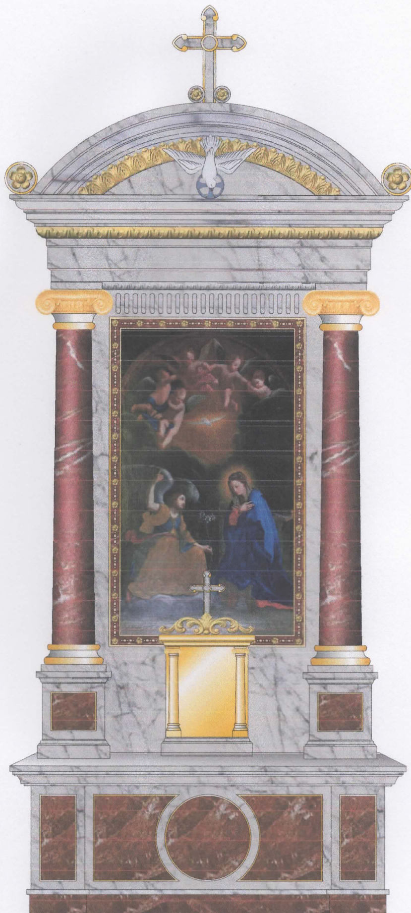
Projekt Ołtarza Głównego ZNMP w Potulicach wykonany z drewna, marmoryzowany na wzór marmurów bianco carrara, rojo alicante, złocenia wykonane 22 karatowym złotem, obraz istniejący. Skala 1:25
